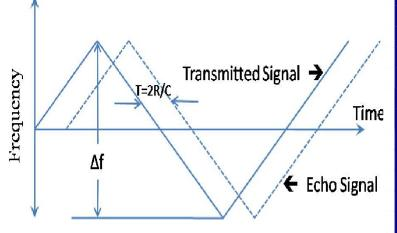
SAW TOOTH WAVE FORM IN FMCW RADAR
